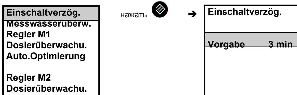
При повторном включении прибора (отключение напряжения в сети и пр.) дозация M1 и M2 включается только по истечении заданного времени замедления.
