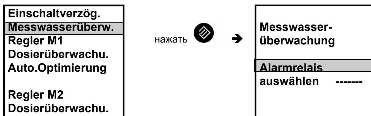
Если для срабатывания тревожной сигнализации о недостаточном уровне измерительной воды требуется подать сигнал на выходное реле (тревожное реле 5), то необходимо ввести его (соответствующее реле) в маркированную строку меню.
